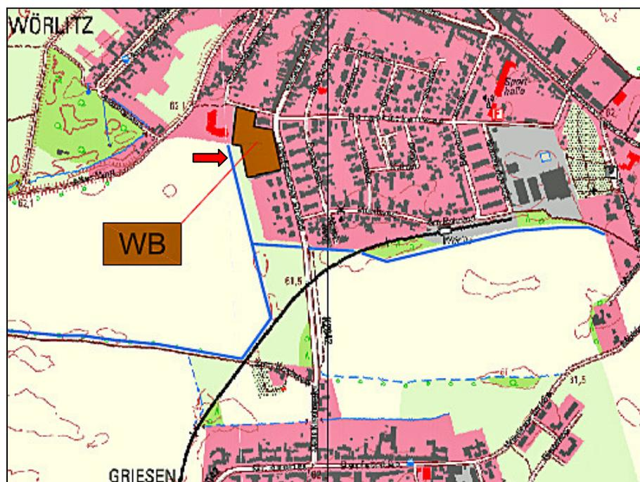
**Abb. 8:** Mögliche Nutzung des örtlichen Grabensystems für den Drosselabfluss der Rigolenversickerung. (roter Pfeil - möglicher Einleitungspunkt). (Darstellung auf der Grundlage von Geobasisdaten © GeoBasis-DE / LVermGeo LSA / www.lvermegeo.sachsen-anhalt.de, Abgabe 2016, Az.: C22-7016280-2016)
